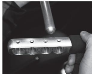
再度、回転防止シャフトを潜らせ再度ハンドルのスポーク幅に適しているか確認します。
