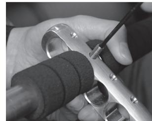
※シャフト側のネジ穴を合わせてからイモネジを奥まで締め付ける。(締め過ぎ厳禁!)
