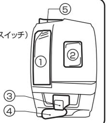
※H1ビームインジゲーター用：ポジションランプ付ヘッドライトに換装されている場合はスイッチ側の茶色リード線端子に結線して下さい。
