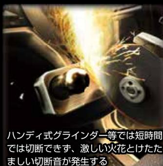
ハンディ式グラインダー等では短時間では切断できず、激しい火花とけたたましい切断音が発生する
