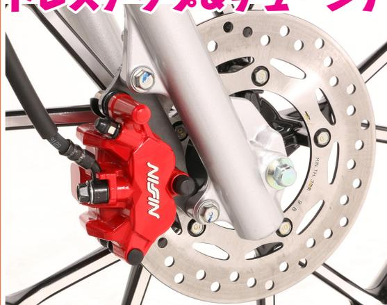
ノーマルの1ポットキャリパーからニッシン社製の2ポットキャリパーに換装し、ストップパワーを向上。カラーバリエーションも**3色設定!!**
