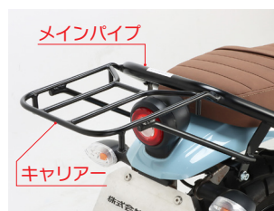
キャリアーとメインパイプはフラットになるように設計されています。
