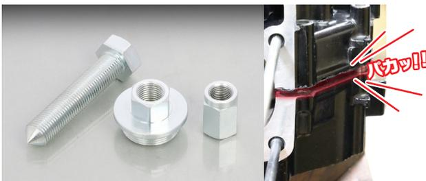
固着したクランクケースを左右に分割する際に便利な専用工具です。左側クランクケースカバーを用いて、クランクケースを手軽に分割できます。
