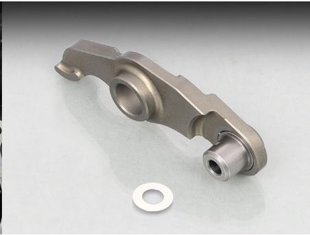
ハイチューンエンジンでの過酷な使用状況ではノーマルカムチェーンテンショナーに変形が発生してしまい、思わぬトラブルの原因となります。SPL カムチェーンテンショナーはアルミ削り出し材を使用し、強度アップを実現。またテンショナープッシュロッド当り面の拡幅化により、変形を防止し、トラブルを予防します。
