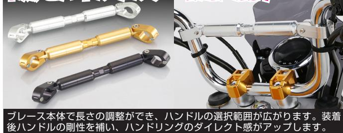
ブレース本体で長さの調整ができ、ハンドルの選択範囲が広がります。装着後ハンドルの剛性を補い、ハンドリングのダイレクト感がアップします。
