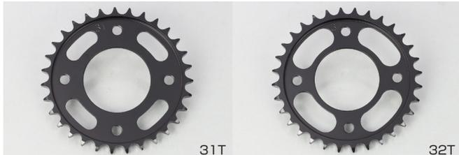
ノーマルの補修や二次減速比のセッティングに。スプロケットは消耗品です。一般公道走行目安として1,000kmごとの点検を推奨します。歯先が細くなっている場合は交換して下さい。
