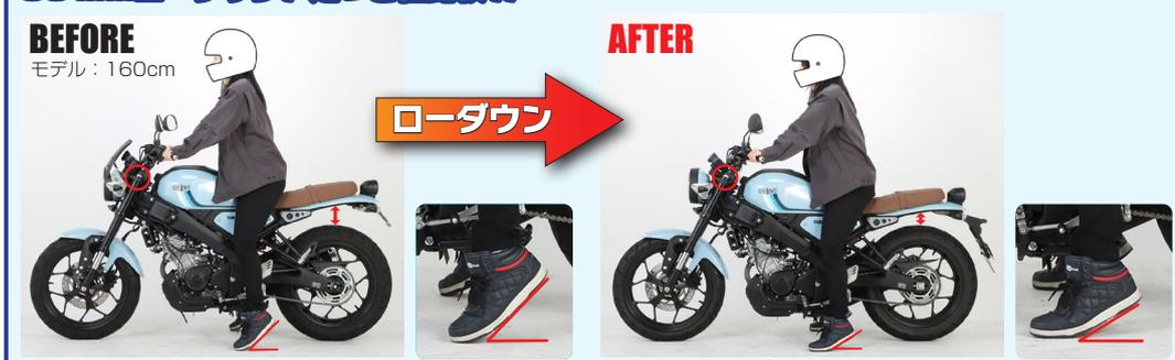
ローダウンリンクプレート交換と同時にフロントフォークの突き出しの変更が必要です。
