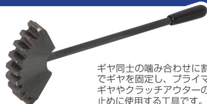
ギヤ同士の噛み合わせに割り込ませる事でギヤを固定し、プライマリードライブギヤやクラッチアウトターの脱着時の回り止めに使用する工具です。
