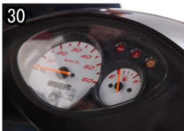
30 メインスイッチをONにします。 ※結線ミス状態でエンジンを始動するとPGM-FI警告灯が点滅するなど、異常検知します。
