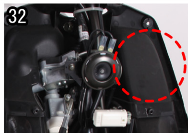
32 i-map本体は雨水がかからない場所に固定して下さい。 あとは、逆手順で外装を組み付けて下さい。
