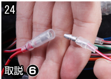
24 取説 ⑥ メスギボシ端子と一緒に圧着し、赤/白色リード線を繋ぎます。
