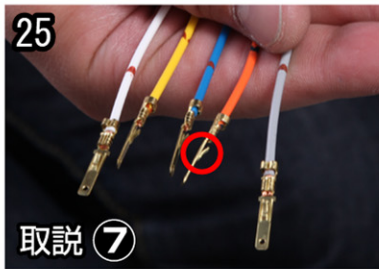
25 取説 ⑦ 取説 ①～⑤ で作業してきたリード線(白/黄/青/橙/灰)の平型端子を、付属の110型6Pカプラー(オス)に取説の図を参考に差し込んでいきます。 ※平型端子を、110型6Pカプラー(オス)に差し込む際、端子には抜け防止用ツメ○があり向きがあります。
