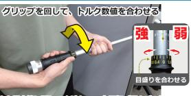
ロックリングを戻して設定完了 締め方向) には使用しないで下さい (正ネジの緩め方向、逆ネジの網
