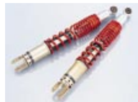
KITACO-SHOWAリアショック 全長:390mm 車高調整機能:+10mm/-5mm プリロード調整機能:7段 2本1セット 520-1805000 ¥22,000
