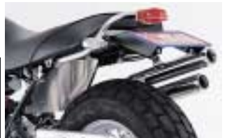
フェンダレスKIT/マッドガード/チェーンケース/リアビッグベグ/ダートトラックTYPEマフラーを装着
